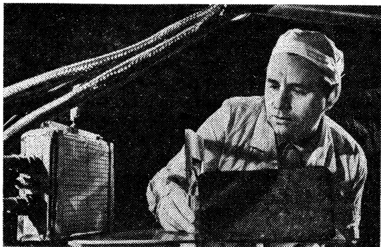
Важную роль при выполнении исследований и отработке новых режимов на ускорителе играет тщательная подготовка к проводимому эксперименту. На снимке: инженер Ю. Ф. Кусагин за установкой сцинтилляционного счетчика интенсивности в канале медленного вывода.
