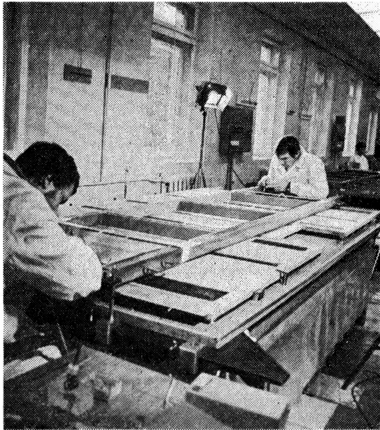
В зале для монтажа сигнальных электродов. Рабочие Н. Н. Щербаков и В. А. Буров производят распайку сигнального электрода пропорциональной камеры.
