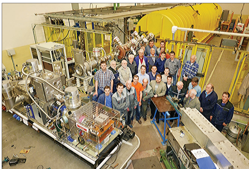
Общий вид зала инжекторов ускорительного комплекса Нуклотрона в ходе подготовки к запуску, на переднем плане – новый инжектор с лазерным ионным источником.
