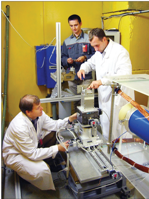
Сотрудники сектора нейтронной оптики научно-экспериментального отдела нейтронных исследований конденсированных сред ОНИРКС ЛНФ И. В. Гапон, О. В. Томчук, А. В. Нагорный (слева направо) проводят настройку нейтронного рефлектометра ГРЭИНС на реакторе ИБР-2. Устанавливается рефлектометрическая ячейка типа «твердый электрод – жидкий электролит» для исследования электрохимических интерфейсов.
