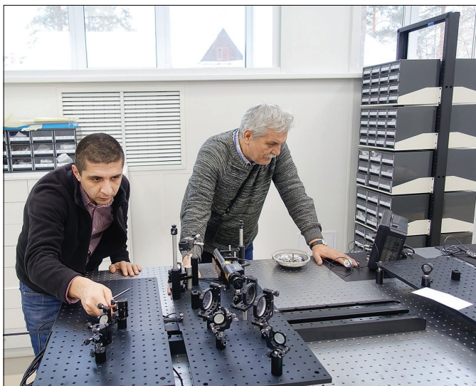
Н. С. Азарян и М. В. Ляблин за юстировкой оптики на абсолютном измерителе длины.
