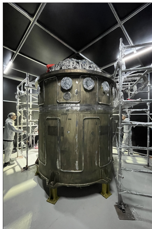
Стальной бак с детектором TAO внутри
