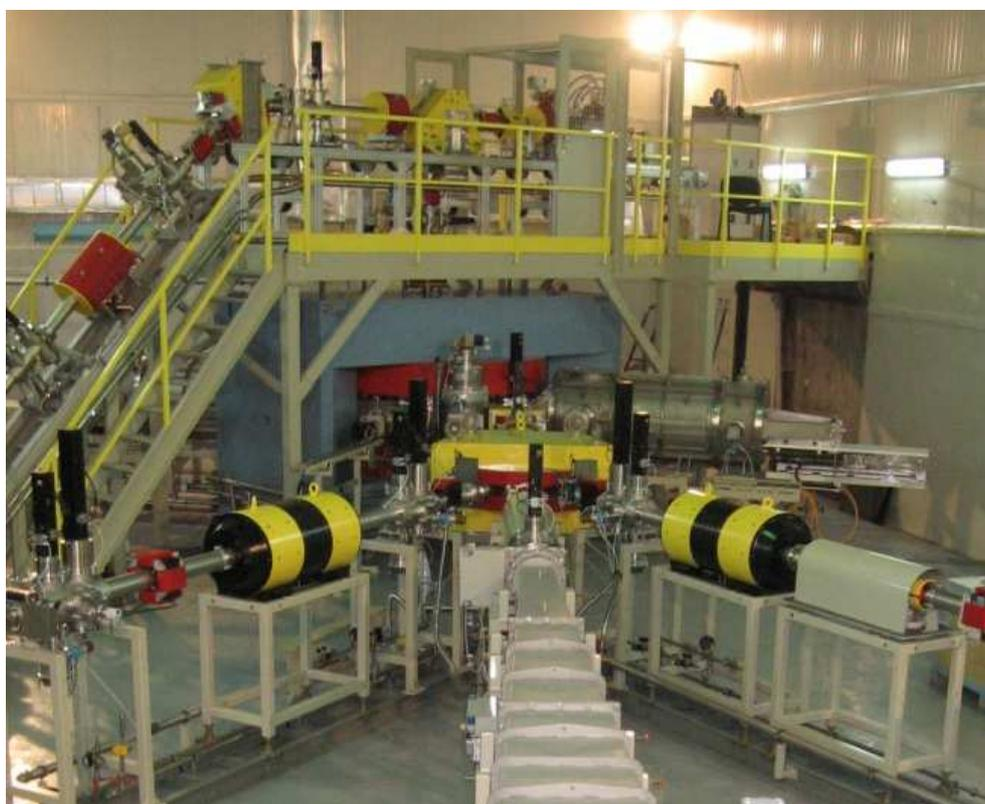
Рис.6. Фотография ДЦ-60. Вверху – ЭЦР источник, линия инжекции и канал ионов низких энергий. Внизу – каналы транспортировки ускоренных пучков и канал трековых мембран
