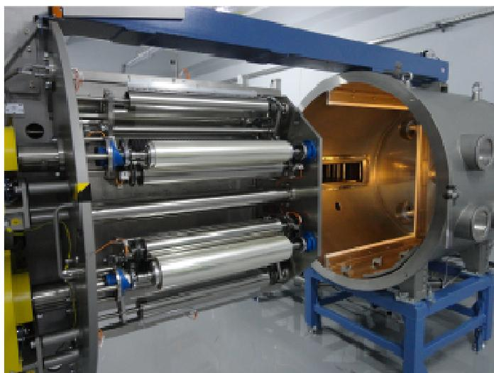
Рис.12. Установка для облучения полимерной пленки
