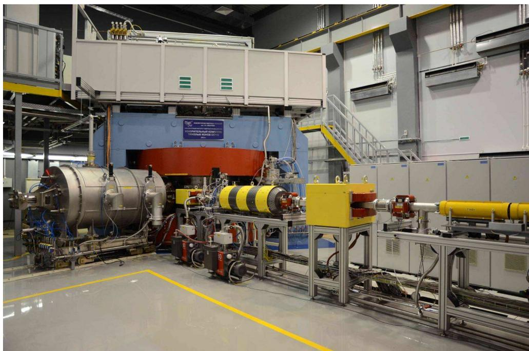
Рис.11. Циклотрон ДЦ-110 и канал транспортировки пучка
