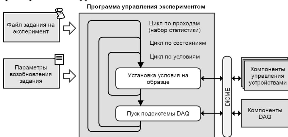
**Рис. 7.** Схема работы программы управления экспериментом
