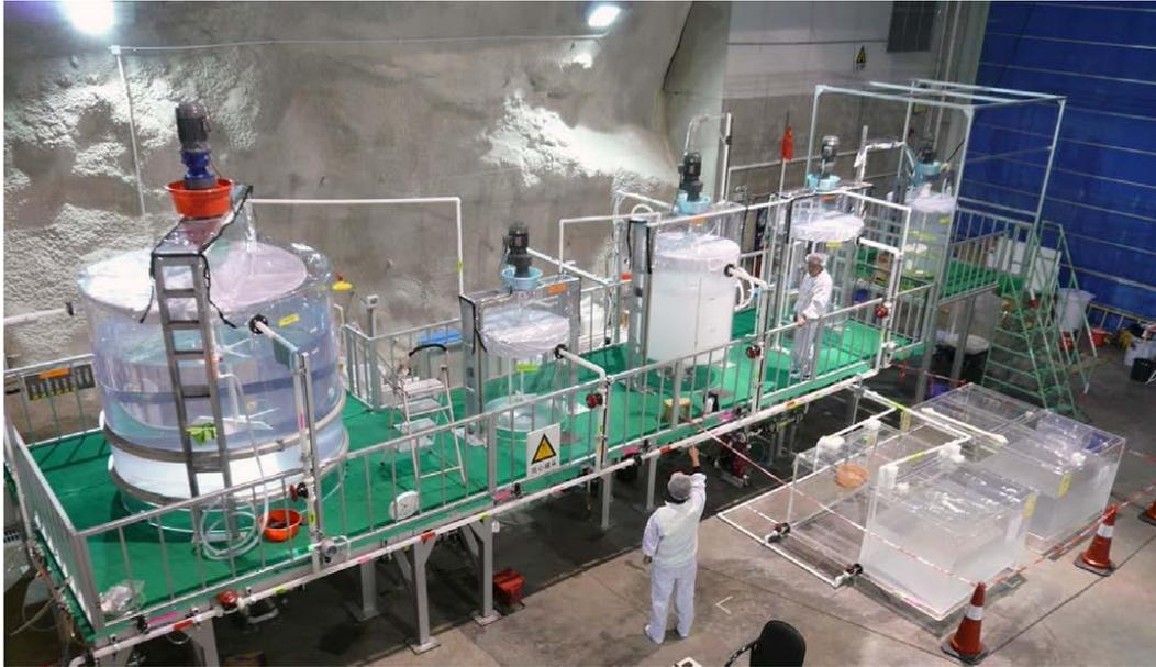
Рисунок 2.24 – Фотография участка по производству жидкого сцинтиллятора «стандартного состава» и гадолинийсодержащего жидкого сцинтиллятора нейтринного эксперимента Daya Bay
