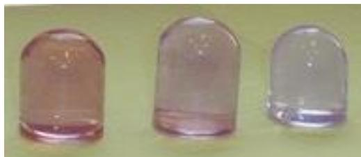
Рисунок 4.5 – Заготовки для неодимсодержащих пластмассовых сцинтилляторов на основе полиметилметакрилата (диаметр – 30 мм)
