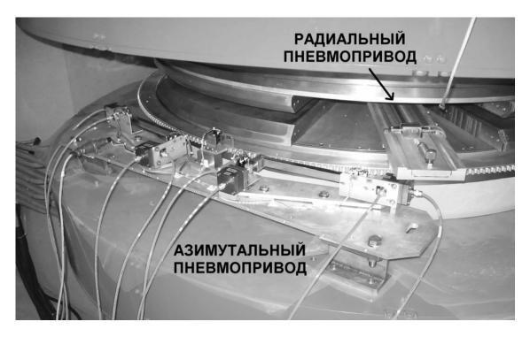
Рис. 6 Размещение системы магнитных измерений в рабочей области электромагнита.
