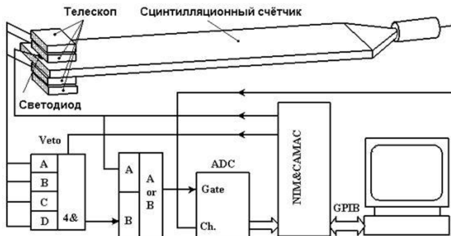
Рис. 23: Схематическое представление стенда для измерения параметров сцинтилляционных счетчиков старого типа
