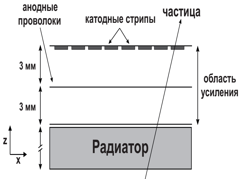
Рис. 12: Схема одного модуля детектора TRD
