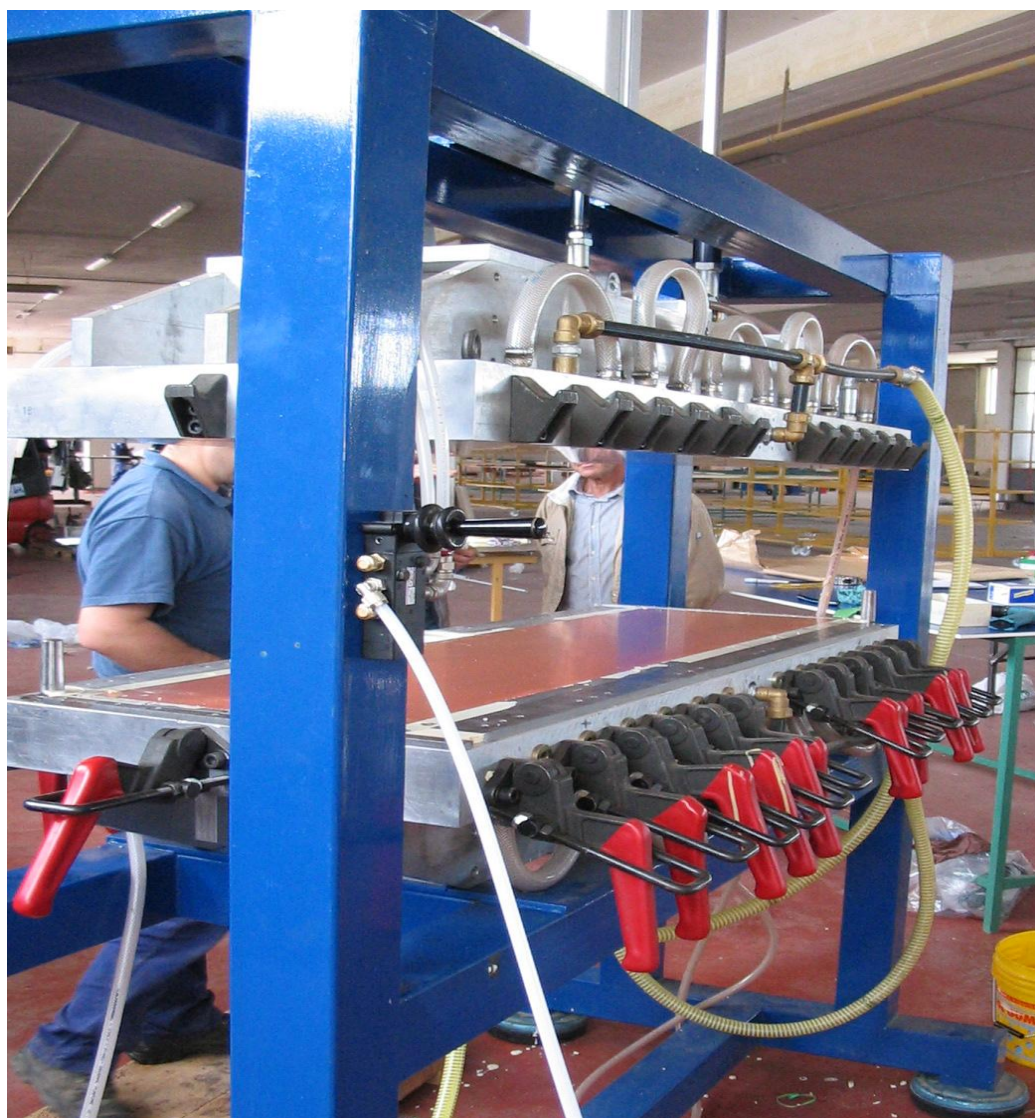
Рис. ПЗ.1. Оборудование для производства панелей с пенополиуритановым наполнением типа Chempr Core 75 (75 обозначает плотность 75 \text{ мг/см}^3 ); заказчик – мюонная коллаборация LHCb; подрядчик – итальянская фирма Commerciale Italiana (Lodi, Italy).
