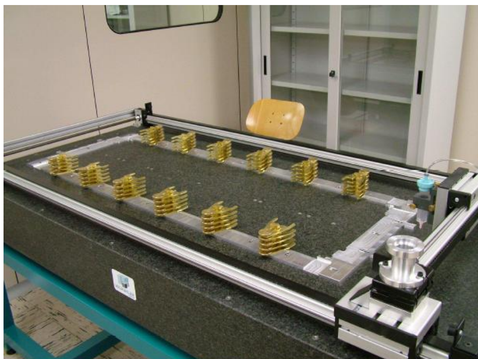
Рис. ПЗ.7. Установка для обжима слоев четырехслойной камеры при склеивании камеры.
