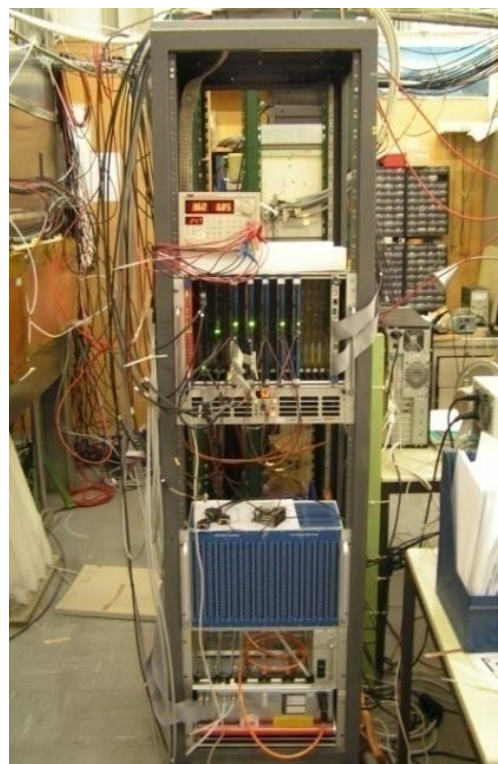
Рис. 5.1. Специальный стенд ( mockup – тренажер) для тестирования камер на космических лучах в лаборатории, конструктивно повторяющий стенку станции в шахте (а) и стойка системы сбора данных DAQ (б).
