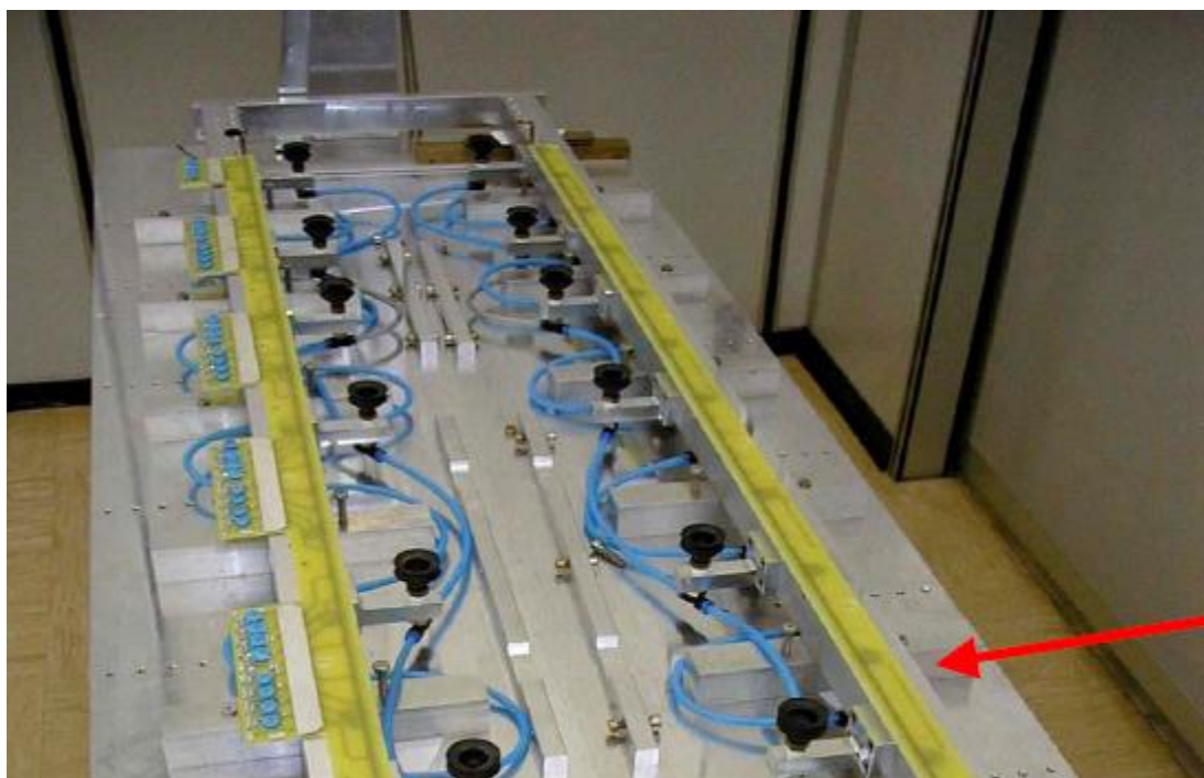
Рис. ПЗ.3. Монтажный стол с вакуумными прижимами для приклеивания баров и спэйсеров.
