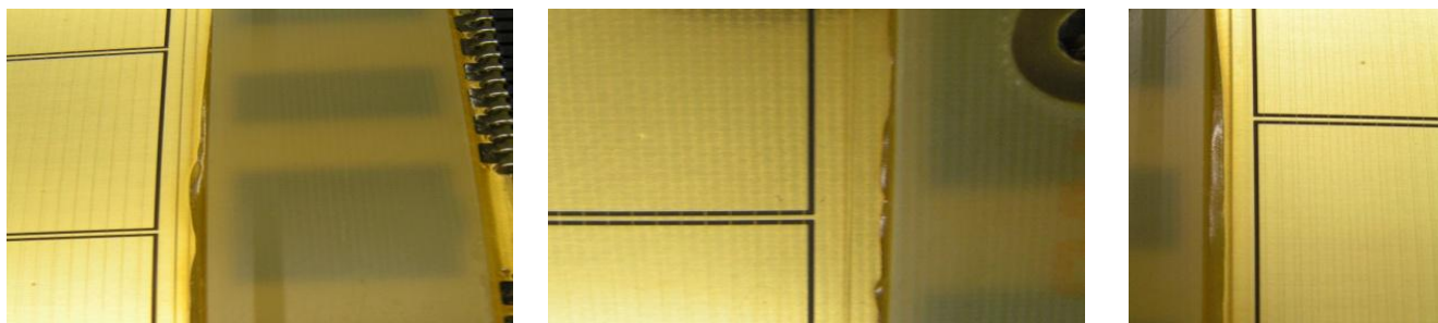
Рис. 3.36. Эпоксидная смола, выдавленная из-под спэйсеров из-за нарушенной дозировки при автоматическом нанесении ее на бары (см. Приложение ПЗ.2).
