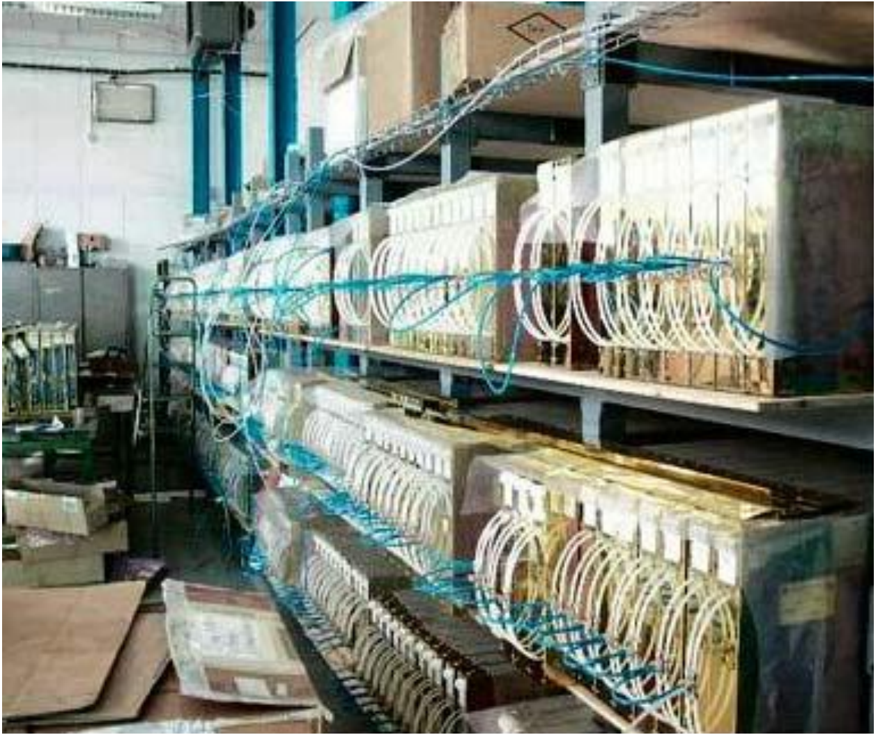
Рис. ПЗ.12. Хранение камер на стеллажах с непрерывным продувом зазоров чистым азотом.
