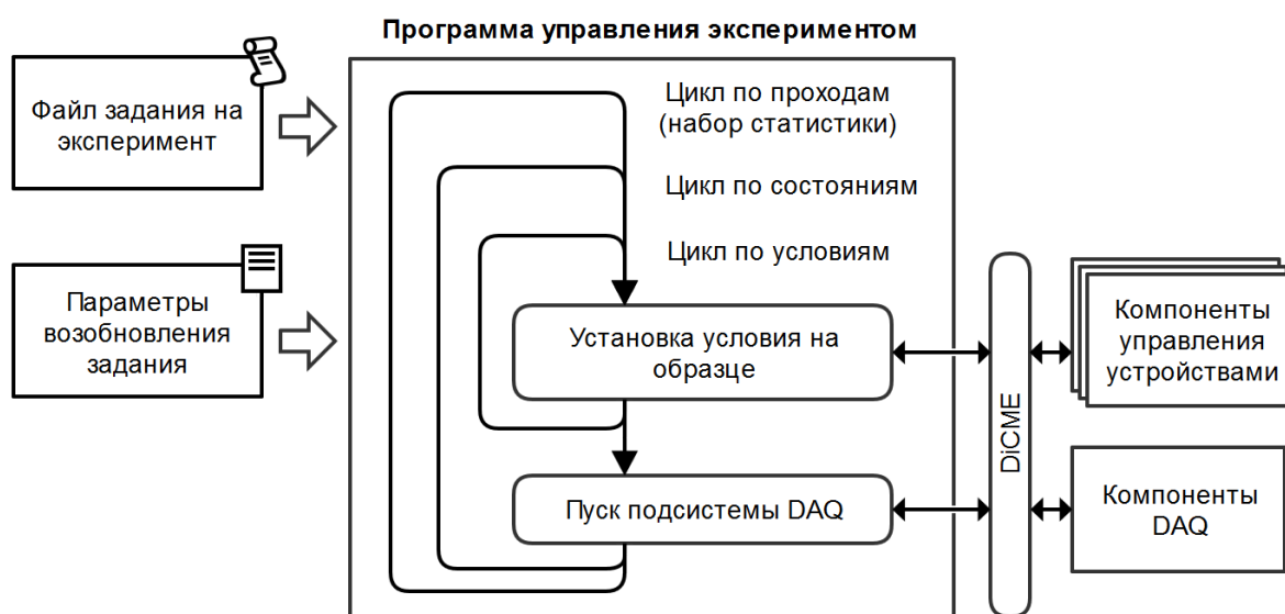
Рис. 5.4. Схема работы программы управления экспериментом
