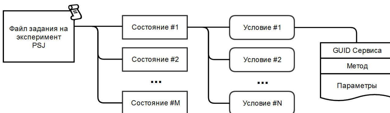
Рис. 3.3. Структура файла задания на эксперимент
