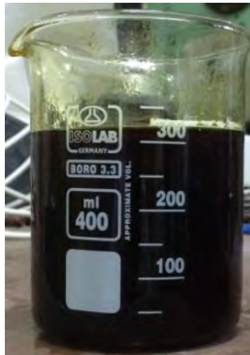
Рис. 46. Расплавленная облученная смесь мезитилена и м-ксилола
