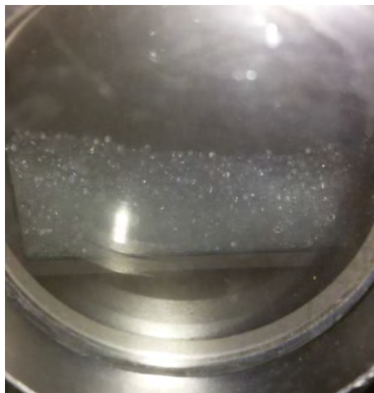
Рис. 41. Снимок камеры-имитатора во время проведения эксперимента. Температура внутри камеры T = 80\text{ K} . Загружено \sim 15000 шариков (0,5 л).
