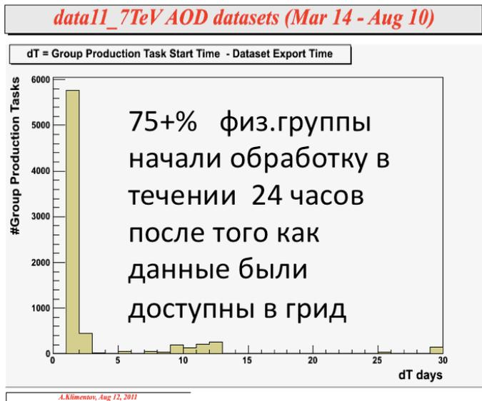
Рисунок 39 - Время задержки при начале обработки данных физическими группами
