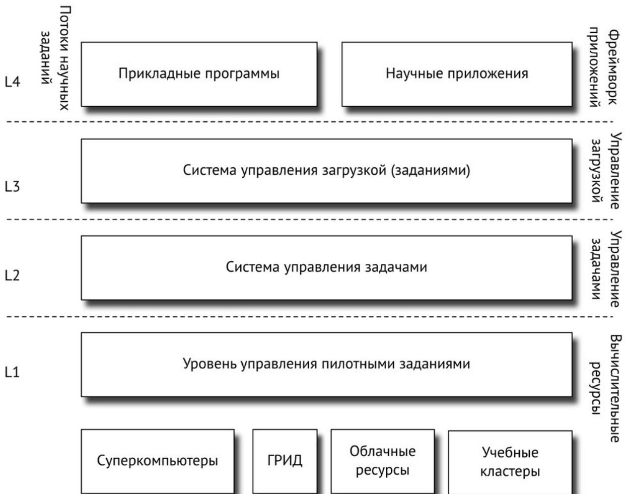
Рисунок 35 - Схема интеграции системы управления загрузкой и вычислительных мощностей
