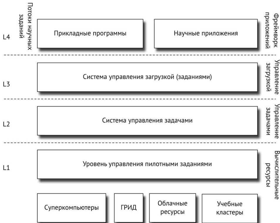
Рисунок 7. Иерархия базовых уровней системы управления загрузкой и вычислительных мощностей для обработки данных в гетерогенной компьютерной среде
