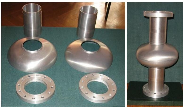
Рисунок 29 – Изготовленные детали одноячеечного резонатора из ниобия (слева) и резонатор в сборе (справа)
