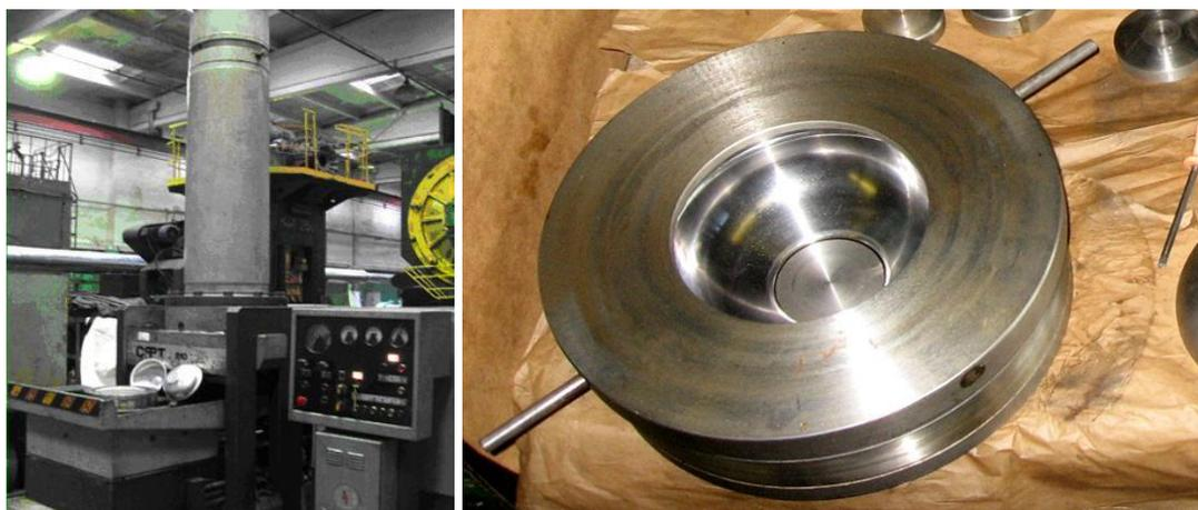
Рисунок 26 – Гидроударный пресс СФТ-510 в ФТИ НАНБ (слева) и оснастка для штамповки полуячеек резонатора (справа)
