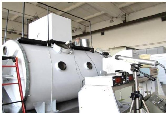
Рисунок 30 – Установка для электронно-лучевой сварки в ФТИ НАНБ
