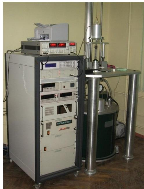
Рисунок 39 – Установка «Liquid Helium Free High Field Measurement System», применённая в электрофизических испытаниях при температурах 2-300 К.
