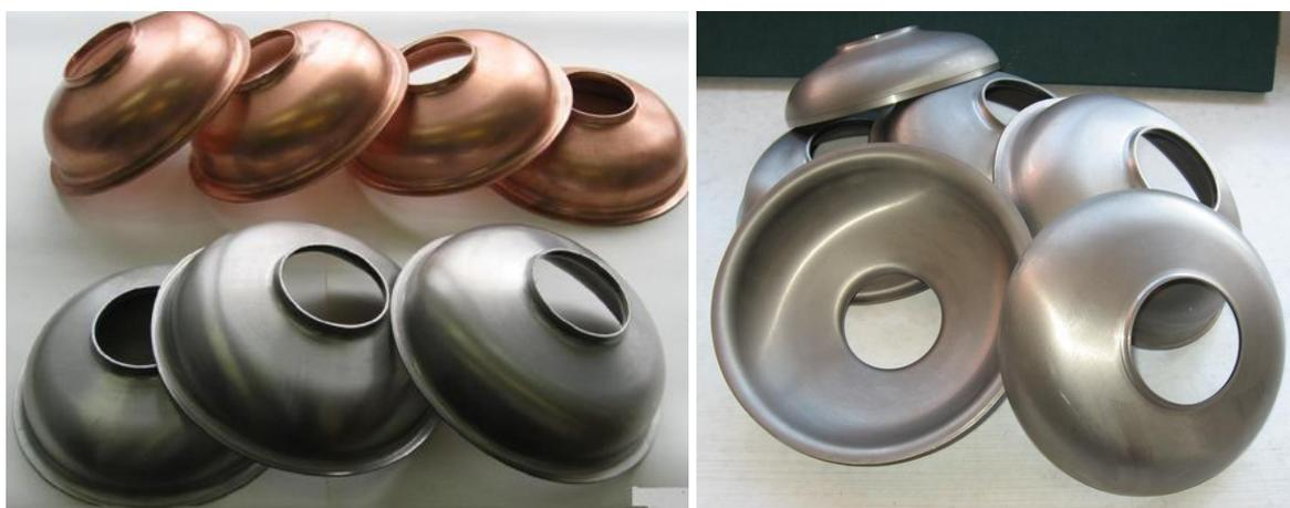
Рисунок 27 – Полуячейки резонатора, отштампованные на гидроударном прессы СФТ-510: слева – из модельных материалов М1М и АМцМ, справа – из листового ниобия высокой чистоты от Ningxia
