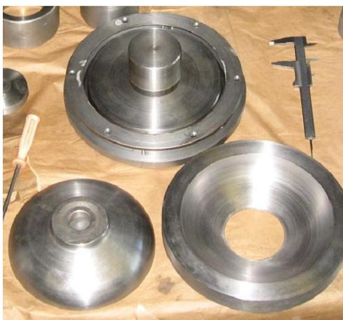
Рисунок 28 – Детали устройства механической обработки полуячеек
