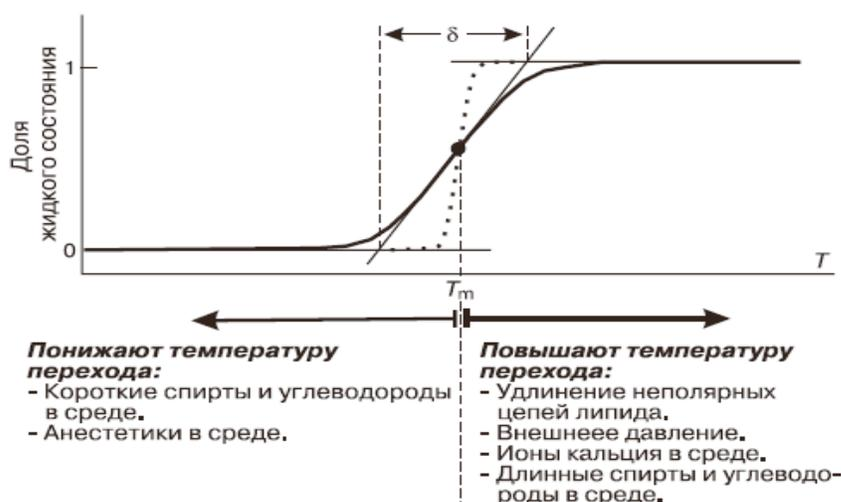
**Рис. 1.8.** Факторы, влияющие на повышение или понижение температуры главного фазового перехода.
