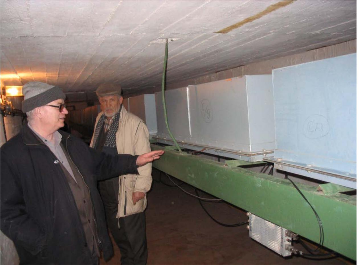
Рис. 3.3. Подземный мюонный детектор Якутской установки ШАЛ площадью 20 квадратных метров [246].
