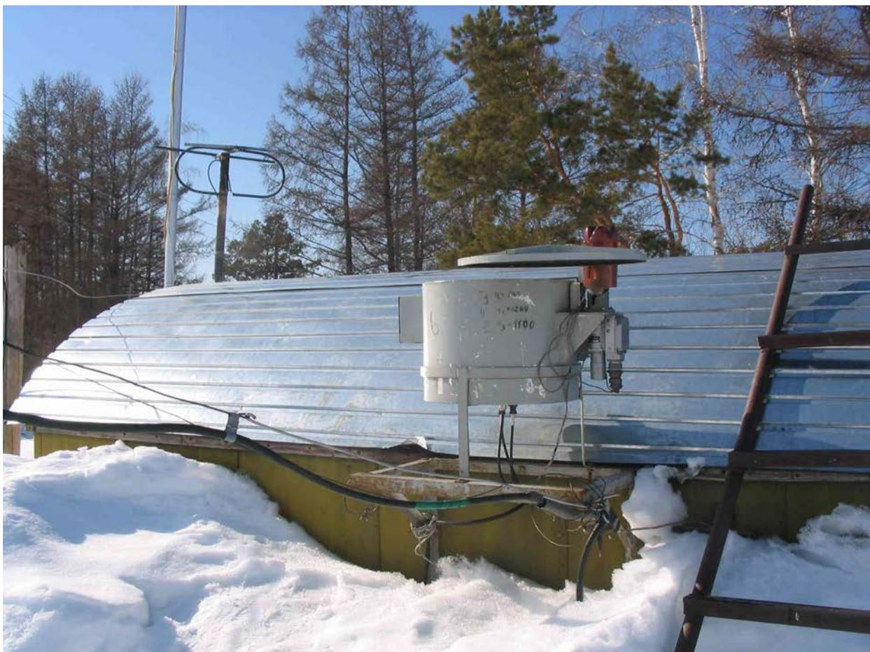
Рис. 3.2. Станция наземной решетки Якутской установки ШАЛ с установленным на ней детектором черенковского излучения [246].
