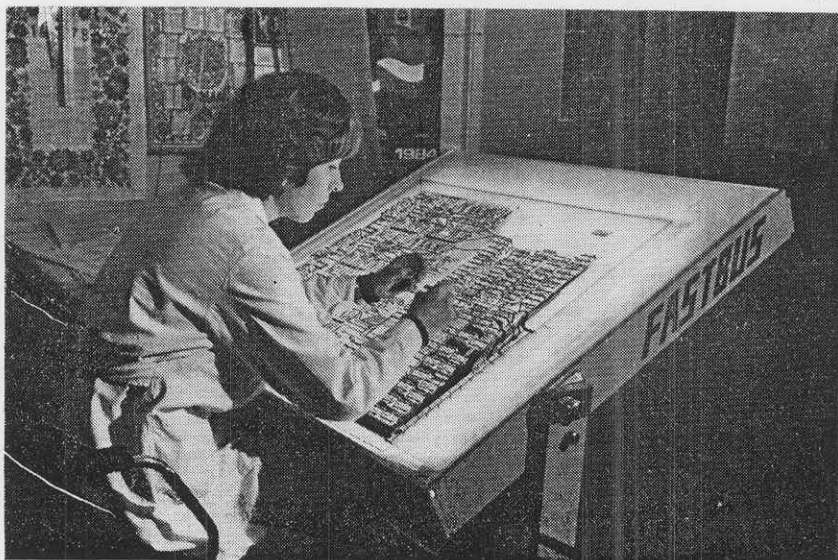
Радиомонтажница 8-го разряда В. И. Максименкова за изготовлением фотошаблона печатной платы в стандарте ФАСТБАС. Фото Н. ПЕЧЕНОВА.
