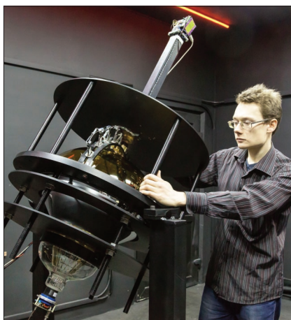
Дмитрий Федосеев устанавливает фотоэлектронный умножитель в сканирующую станцию в темной комнате.
