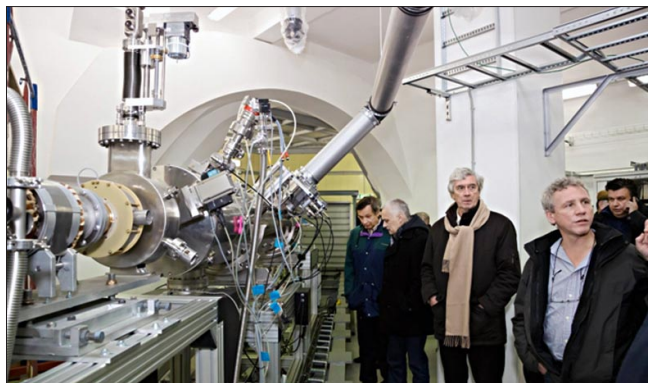
Первая секция линейного ускорителя тяжелых ионов в процессе подготовки к испытанию с пучком частиц.
