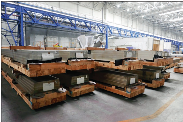
Балки и полюса магнитопровода в цехе VHM, г. Острава.
