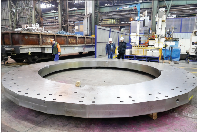
Опорное кольцо после финишной обработки, VHM.
