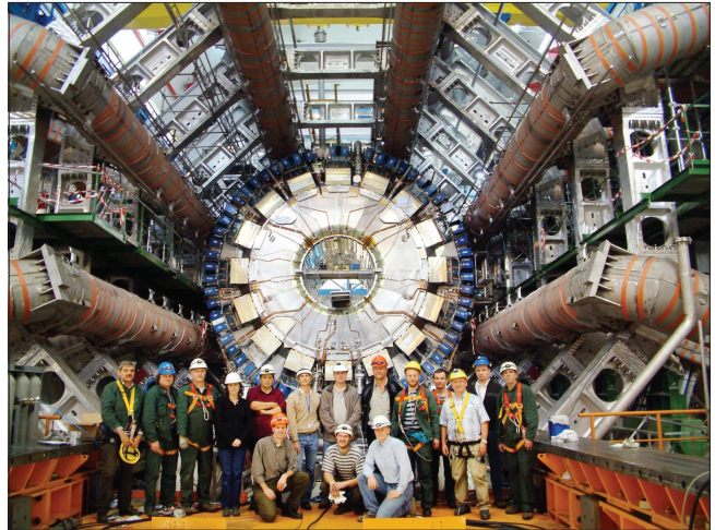
Центральная «бочка» адронного калориметра установки ATLAS. Фото сделано по окончании передвижения 1600-тонной (вместе с жидкоаргонным калориметром внутри) бочки на нулевую координату.
