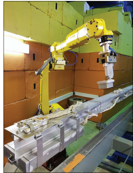
Роботизированный манипулятор перемещает образцы.
