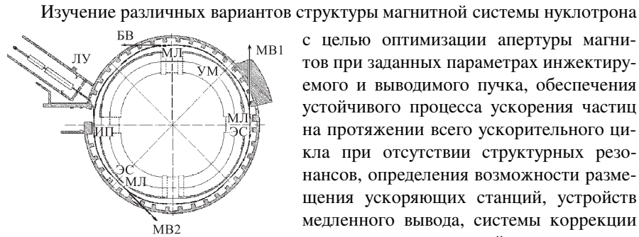
Рис. 11. Схема расположения систем нуклотрона: ЛУ — линейный ускоритель-инжектор, МВ1 и МВ2 — направления каналов медленного вывода, БВ — быстрый вывод, ИП — инфлекторные пластины, ЭС — электростатический септум, МЛ — магнит Ламбертсона, УМ — ударный магнит
