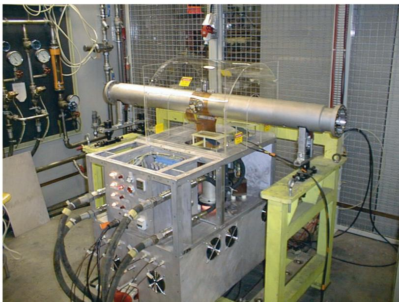
Фото 12. Электростатический дефлектор (сверху) и широкополосный усилитель
