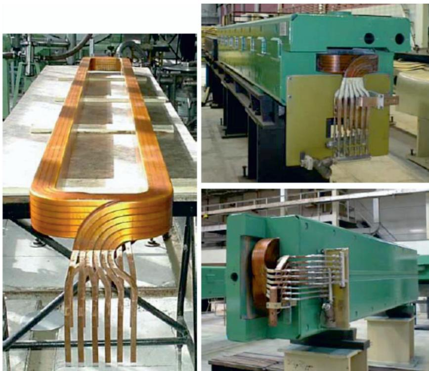
Фото 9. Катушка септум-магнита (слева) и септум-магниты на участке сборки в ГНЦ ИФВЭ (справа)
