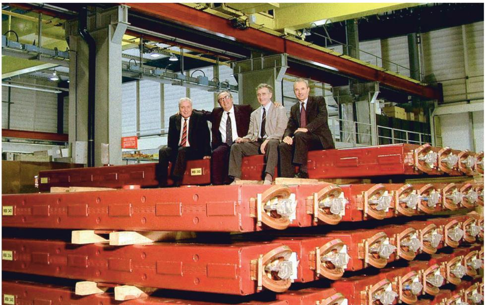
Фото 7. Дипольные магниты для каналов транспортировки пучка на складе в ЦЕРН
