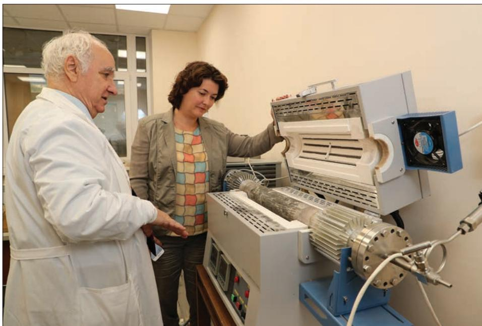
Лаборатория нейтронной физики им. И. М. Франка. М.-Л. Краус и О. А. Куликов осматривают оборудование для получения новых керамических и специальных сплавов при высоких температуре и давлении
