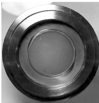
Рис. 8. Внешний вид инфракрасного прогреваемого окна
