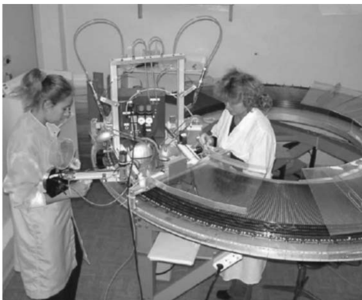
Рис. 23. Установка анодных проволок в строу
