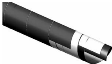
Рис. 11. Схематичное изображение конструкции строу
