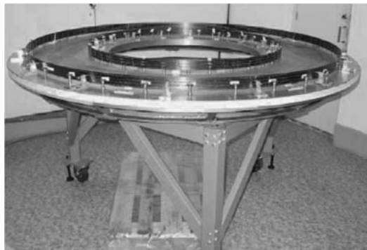
Рис. 18. Сборочный стол с установленными композитными кольцами
