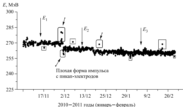
Рис. 13. Измеренное значение энергии пучка тяжелых ионов. Эксперимент соответствует трем энергиям пучка ( E_{1-3} ). Прямоугольники — относительно плохие формы импульсов с пикап-электродов, измеренное значение не соответствует реальности
