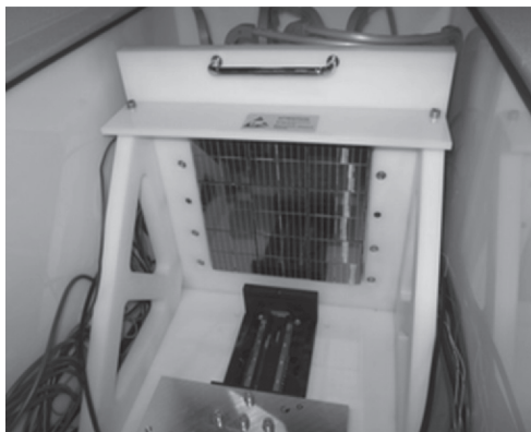
Рис. 4. Прототип FARICH с матрицей на основе Philips dSiPM
