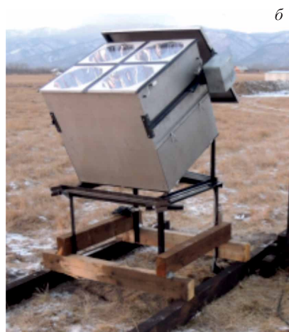
Рис. 2. Схема (а) и фото (б) контейнера с ФЭУ оптической станции установки TAIGA-HiSCORE
