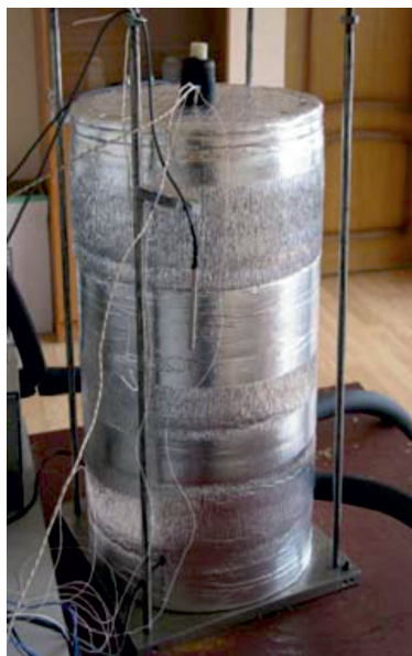
Рис. 4. Чертеж и фотографии измерительной ячейки калориметра без и с теплоизоляцией
