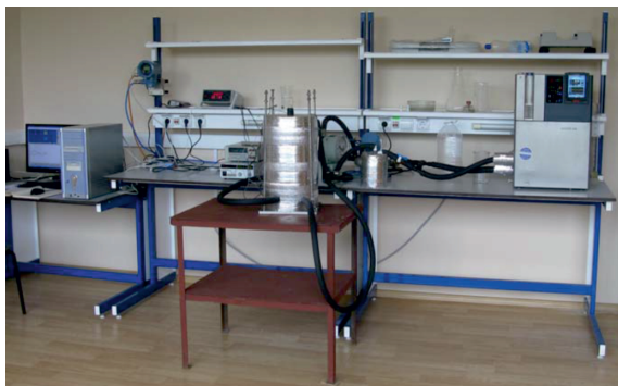
Рис. 5. Калориметрическая система измерения активности искусственного источника нейтрино на основе ^{51}\text{Cr}
