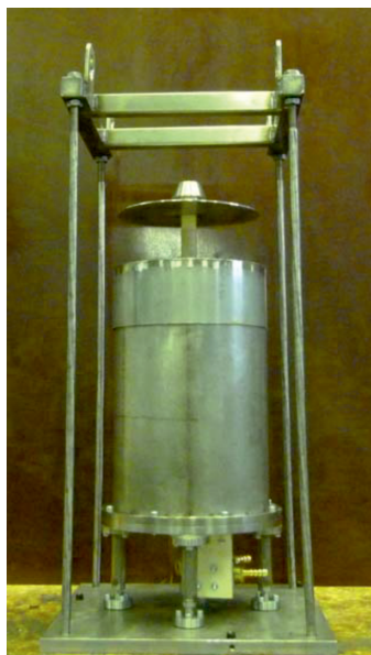
Рис. 4. Чертеж и фотографии измерительной ячейки калориметра без и с теплоизоляцией
