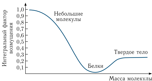
Рис. 23. Зависимость фактора возмущения угловой корреляции от размера молекулы
