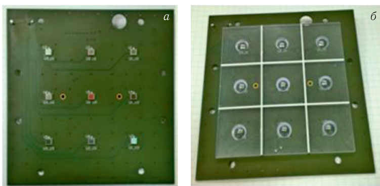
Рис. 45. Модуль для исследований из девяти тайлов из облученного сцинтиллятора: а) печатная плата с установленными девятью SiPM; б) девять тайлов с лунками
