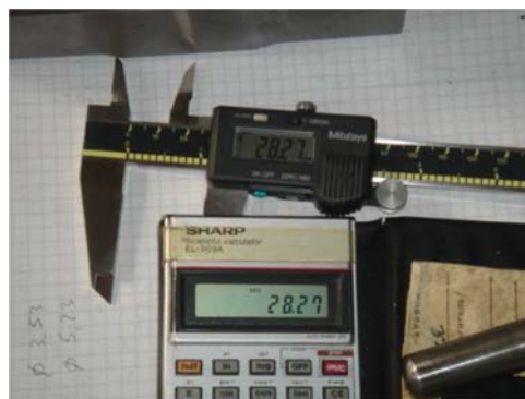
Рис. 7. Расчетные размеры расстояния между отверстиями совпали с измеренными размерами
