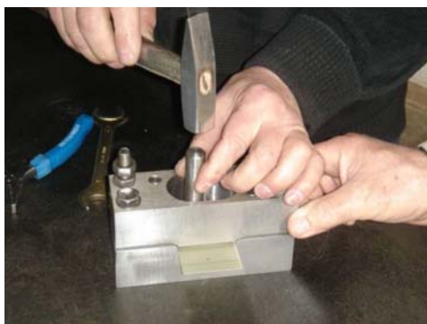
Рис. 8. Пробная просечка отверстий в углепластике
