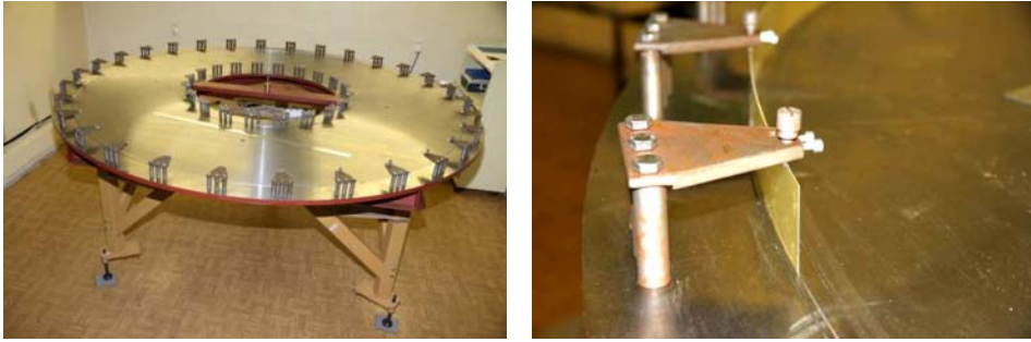
Рис. 5. Общий вид монтажного стола и кронштейна для фиксации ленты
