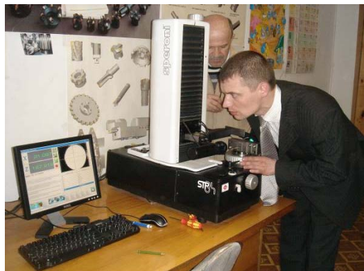
Рис. 10. Измерение диаметров отверстий в приспособлении
