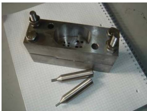
Рис. 6. Внешний вид кондуктора с пробойниками
