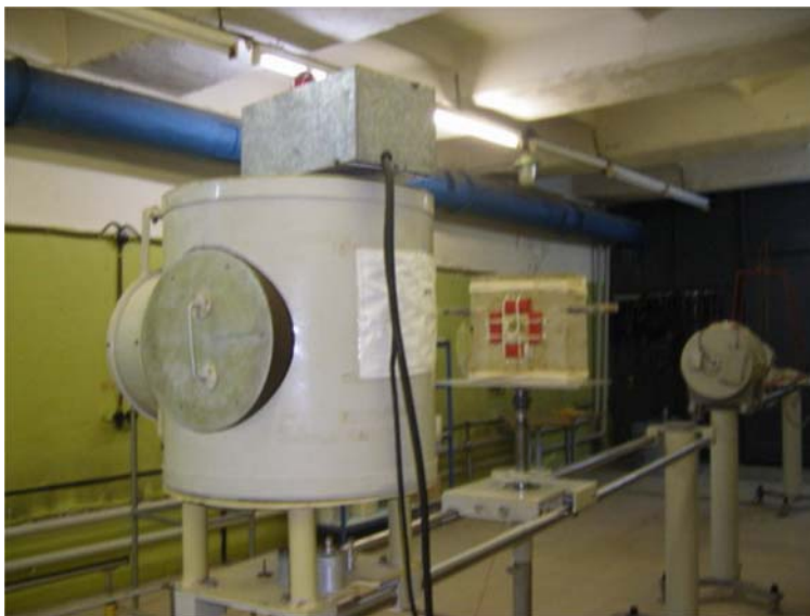
Рис. 5. Общий вид установки УКПН-1М и геометрия облучения дозиметров
