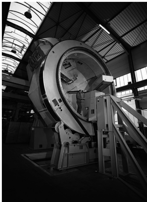
Рис. 6. Изоцентрические гантри. Вес 100 т, диаметр 10 м
