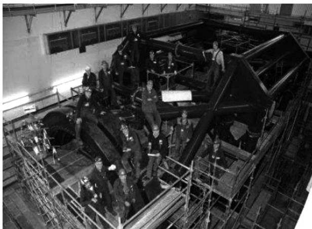
Рис. 11. Гантри весом 630 т вращаются вокруг пациента. Точность наведения пучка в поле облучения не хуже чем \pm 0,5 мм
