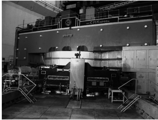
Рис. 1. Синхроциклотрон ОИЯИ с энергией протонов 680 МэВ. Для протонной терапии энергия пучка понижается системой деградеров с 650 до 170 МэВ, и затем пучок протонов транспортируется в специальное помещение, где проводятся сеансы терапии. Вес магнита фазотрона 6000 т
