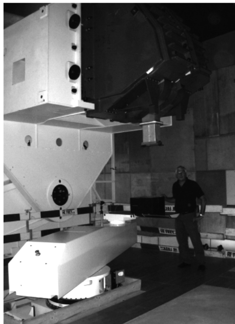
Рис. 7. Система формирования пучка в зоне облучения — так называемый «nozzle»
