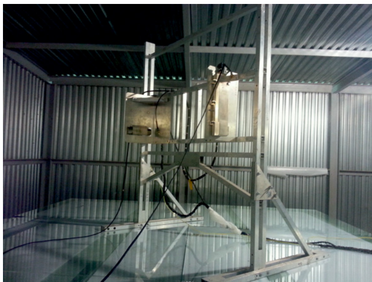
Рис. 3. Механическая оснастка с научной аппаратурой ДАН, установленная над моделью марсианского грунта
