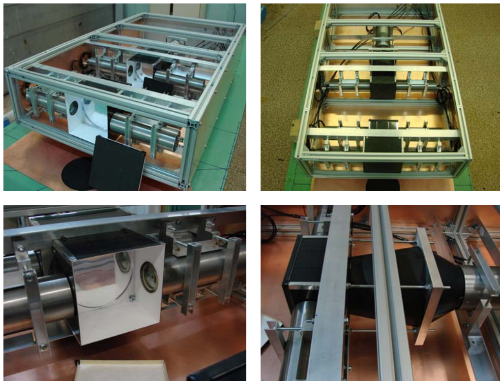
Рис. 3. Общий вид детектора в оптическом ящике и отдельные узлы детектора
