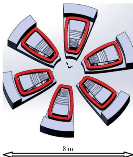
Рис. 8. Магнитная система бустерного циклотрона с уровнем поля 1,6 Тл
