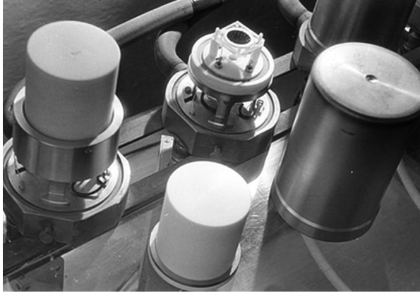
Рис. 1. Детектирующие измерительные камеры. Показан один из двух детекторов в открытой камере. Камера слева — открыта внешняя оболочка
