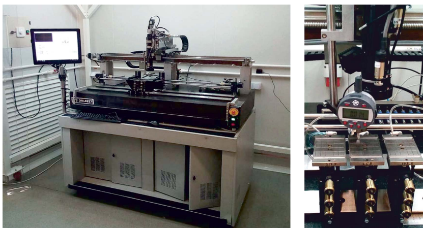
Рис. 6. Фото УС (слева), столиков для сенсоров с регулировочными винтами и объектива целеуказательной камеры с закрепленным микрометром (справа)
