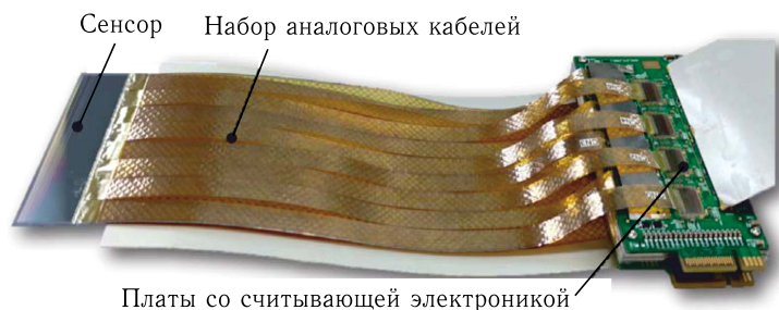
Рис. 2. Фотография собранного модуля КТС VM@N
