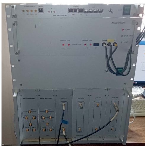
Рис. 5. Электроника системы измерения бетатронных частот
