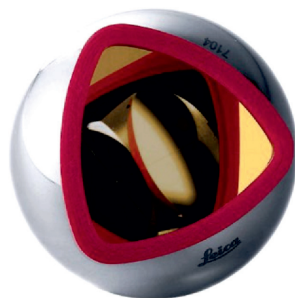
Рис. 3. Ударопрочный отражатель BRR (Break Resistant Reflector) для лазерного трекера AT401 (радиус (19,05 \pm 0,0025) мм, отклонение от сферы менее 0,0015 мм)
