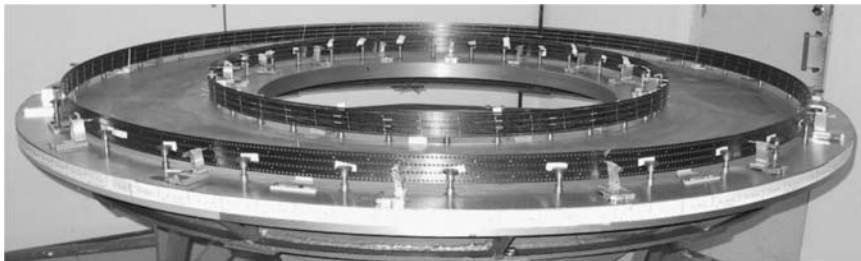
Рис. 4. Кольца внутреннее (В1) и внешнее (В2), подготовленные к установке в них строу
