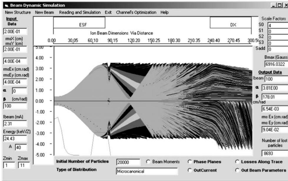
Fig. 4. Argon ion trajectories
