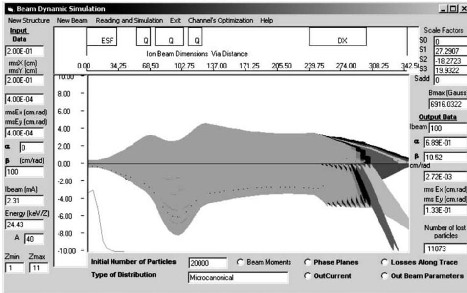
Fig. 21. Argon ion trajectories
