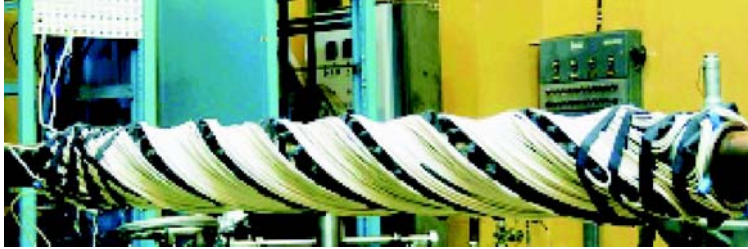
Рис. 1. Спиральный квадруполь. Длина линзы равна двум шагам спирали
