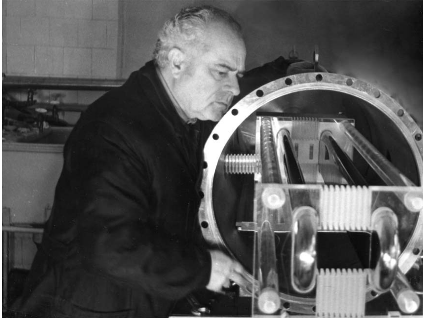
Н. Т. Кашукеев за наладкой установки по измерению верхней границы существования электрического заряда у нейтрона. Дубна, октябрь 1989 г.
