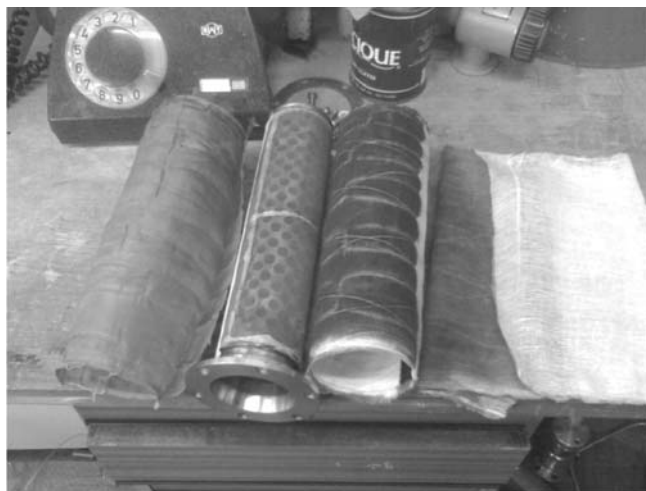
Рис. 2.1. Фильтрующие элементы водородно-неоновых адсорберов, разобранных по завершении 40-го сеанса
